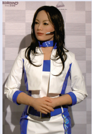
©KOKORO CO., LTD. 「アクトロイド-EXPO」 NEDO 技術開発機構の「次世代ロボット実用 化プロジェクト」の一環で（株）ココロが開発
